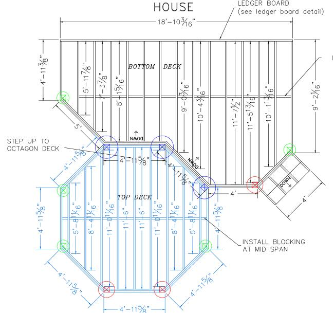
INSTALL BLOCKING AT MID SPAN
